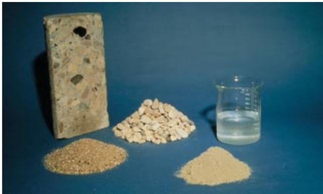
**Fig. 1-1. Componentes del concreto: cemento, agua, agregado fino, agregado grueso, son combinados para formar el concreto. (IMG12501)**
