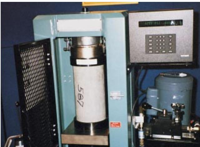
Fig. 1-18. Ensayo a compresión de cilindro de concreto de 150 x 300-mm (6 x 12-pulg.). La carga en el ensayo es registrada en la carátula. (IMG12500)
