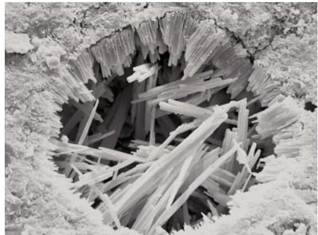
**Fig. 1-35. Depósitos blancos de etringita secundaria en un vacío. Ancho del campo 64 µm (IMG12494)**
