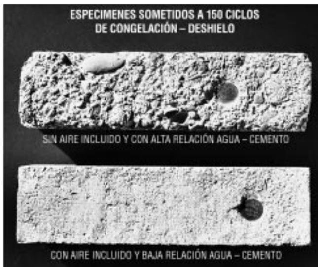
Fig. 1-25. El concreto con aire incluido (barra de abajo) es muy resistente a ciclos repetidos de congelamiento y deshielo. (IMG12294)
