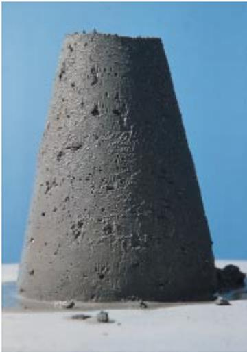
**Fig. 1-10. Concreto con consistencia rígida (bajo asentamiento o bajo revenimiento) en cono de Abrams o cono de revenimiento). (IMG12291)**
